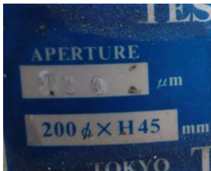
ภาพที่ 6 เครื่องร่อนผ่านตะแกรงความละเอียด 130 ไมครอน
