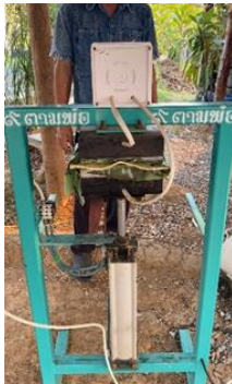
(ก) การขึ้นรูปภาชนะบรรจุอาหารด้วยเครื่องอัดขึ้นรูป
