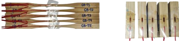
(ก) ตัวอย่างทดสอบกำลังต้านทานแรงดึง (ข) ตัวอย่างทดสอบกำลังต้านทานแรงอัด
