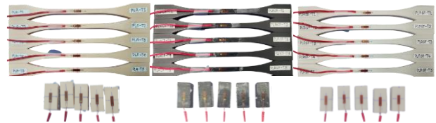
รูปที่ 3 ตัวอย่างทดสอบ PLA+ PLA-CF และ PLA-GF
