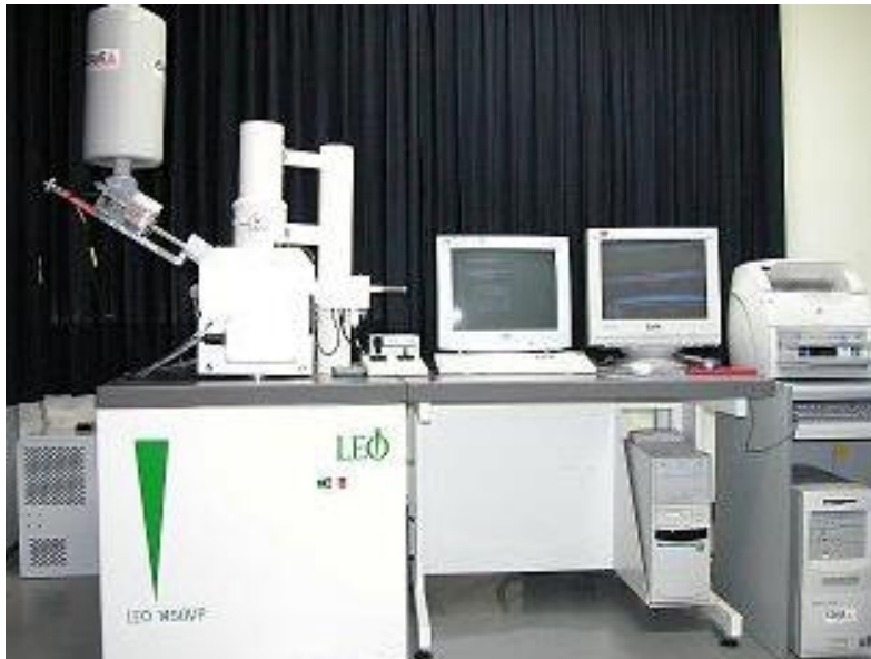
กล้องจุลทรรศน์อิเล็กตรอนแบบส่องกราด (SEM) ยี่ห้อ LEO รุ่น LEO 1450 VP
