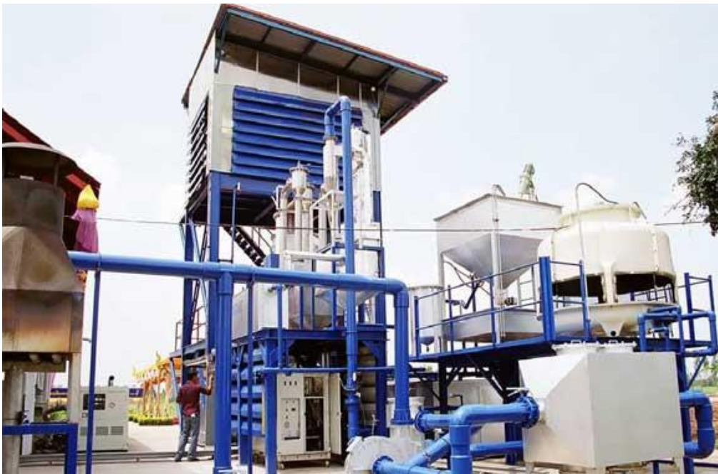
รูปที่ 3 โรงงานผลิตพลังงานจากโรงไฟฟ้าชีวมวลโดยใช้ชานอ้อยเป็นวัตถุดิบ
