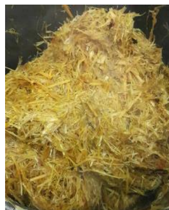
รูปที่ 6 ฟางที่ผ่านการต้มเยื่อและผ่านการล้างเยื่อด้วยถังต้ม
