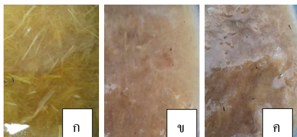
รูปที่ 7 เยื่อฟางที่ผ่านการบดละเอียด: ก. เยื่อฟาง ขนาด 33.4 mm ข. เยื่อฟางขนาด 10.5 mm และ ค. เยื่อฟางขนาด 1.2 mm
